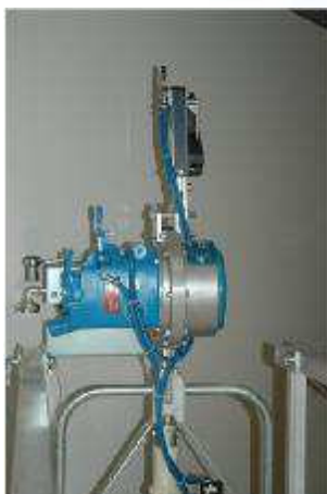
CX 500 z silnikiem o napędzie pneumatycznym i SKY LOCK
