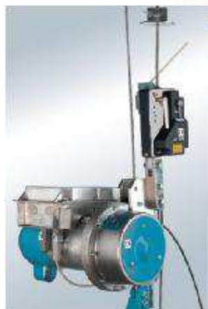
CX 500 z SKY LOCK III montowane na podnośniku
